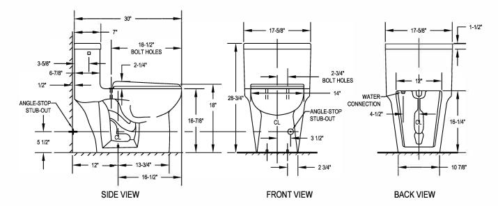
NOTE: DISTANCE FROM WALL TO CLOSET FLANGE CENTERLINE SHOULD BE AS 12" AS SHOWN BELOW.
